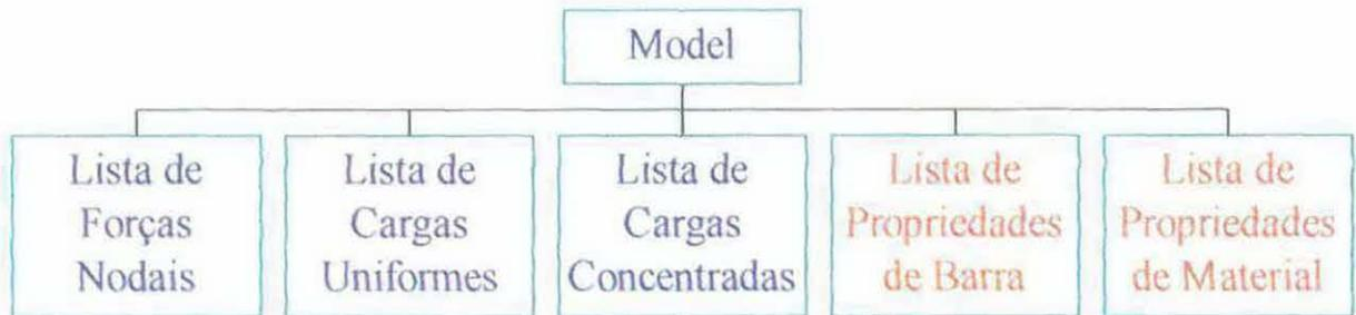
**Fig. 4.3 - Estrutura de dados para o bloco de atributos do modelo.**
