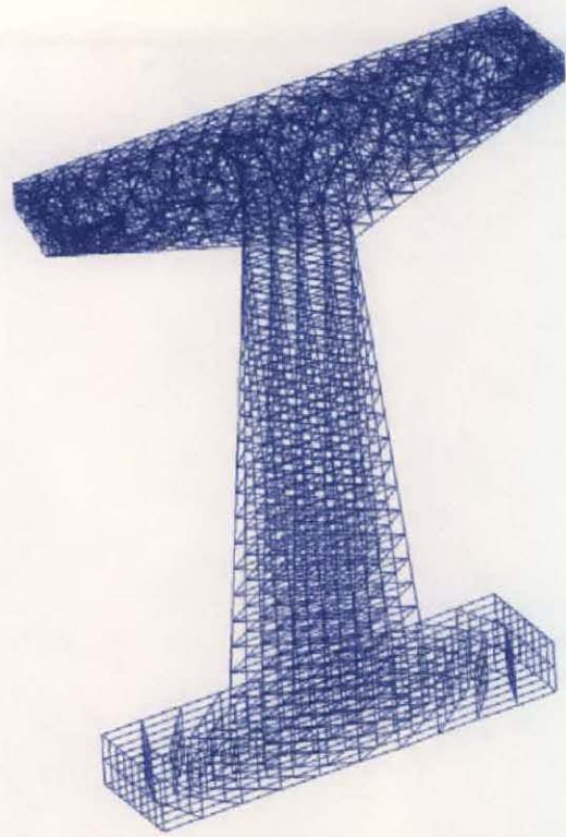
Figura 5.16 - Malhas geradas para a meso-estrutura.
