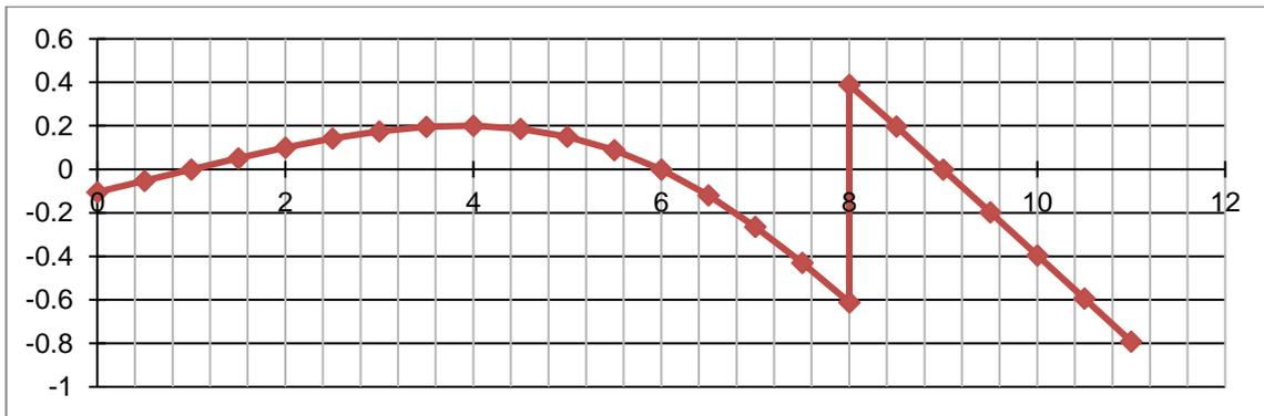
Figura 153 - Línea de influencia de la fuerza cortante  $V_4$
