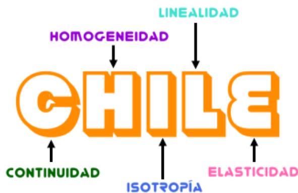
**Figura 17 - Acrónimo resumen de los supuestos que debe cumplir el material de las estructuras para que sean analizadas de forma elástica – lineal**
