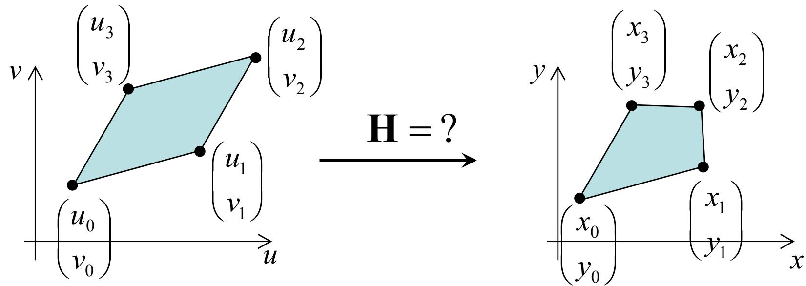
$$\begin{bmatrix} wx \\ wy \\ w \end{bmatrix} = \begin{bmatrix} h_0 & h_1 & h_2 \\ h_3 & h_4 & h_5 \\ h_6 & h_7 & 1 \end{bmatrix} \begin{bmatrix} u \\ v \\ 1 \end{bmatrix}$$
