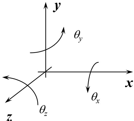
$$\begin{bmatrix} x' \\ y' \\ z' \\ 1 \end{bmatrix} = \begin{bmatrix} 1 & 0 & 0 & 0 \\ 0 & \cos \theta_x & -\sin \theta_x & 0 \\ 0 & \sin \theta_x & \cos \theta_x & 0 \\ 0 & 0 & 0 & 1 \end{bmatrix} \begin{bmatrix} x \\ y \\ z \\ 1 \end{bmatrix}$$
