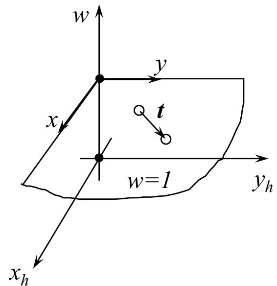
$$\begin{bmatrix} x' \\ y' \\ 1 \end{bmatrix} = \begin{bmatrix} 1 & 0 & t_x \\ 0 & 1 & t_y \\ 0 & 0 & 1 \end{bmatrix} \begin{bmatrix} x \\ y \\ 1 \end{bmatrix}$$
