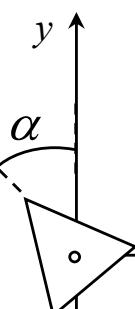
$$\begin{bmatrix} x' \\ y' \\ 1 \end{bmatrix} = \begin{bmatrix} 1 & 0 & x_0 \\ 0 & 1 & y_0 \\ 0 & 0 & 1 \end{bmatrix} \begin{bmatrix} \cos \alpha & -\sin \alpha & 0 \\ \sin \alpha & \cos \alpha & 0 \\ 0 & 0 & 1 \end{bmatrix} \begin{bmatrix} 1 & 0 & -x_0 \\ 0 & 1 & -y_0 \\ 0 & 0 & 1 \end{bmatrix} \begin{bmatrix} x \\ y \\ 1 \end{bmatrix}$$
