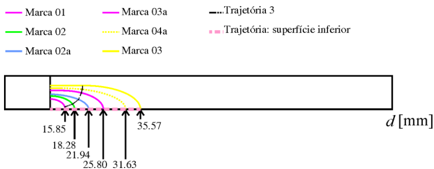
Figura 7.17 – Trajetórias da trinca adotada na superfície inferior da placa e trajetória 3.
