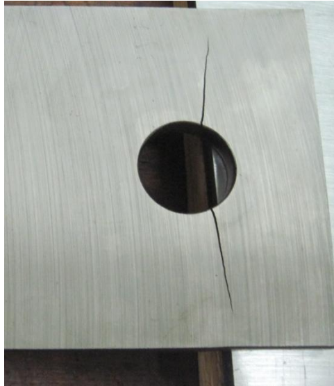
Figura A3. 5 – Trinca no furo do CP05.
