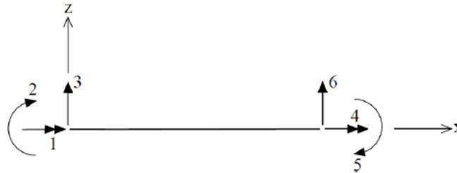
Figura 2.8 – Enumeração dos graus de liberdade de um elemento de grelha
