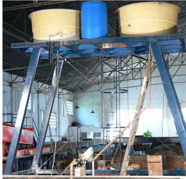
Figura 32 - Reservatório elevado, utilizados para armazenar a mistura
