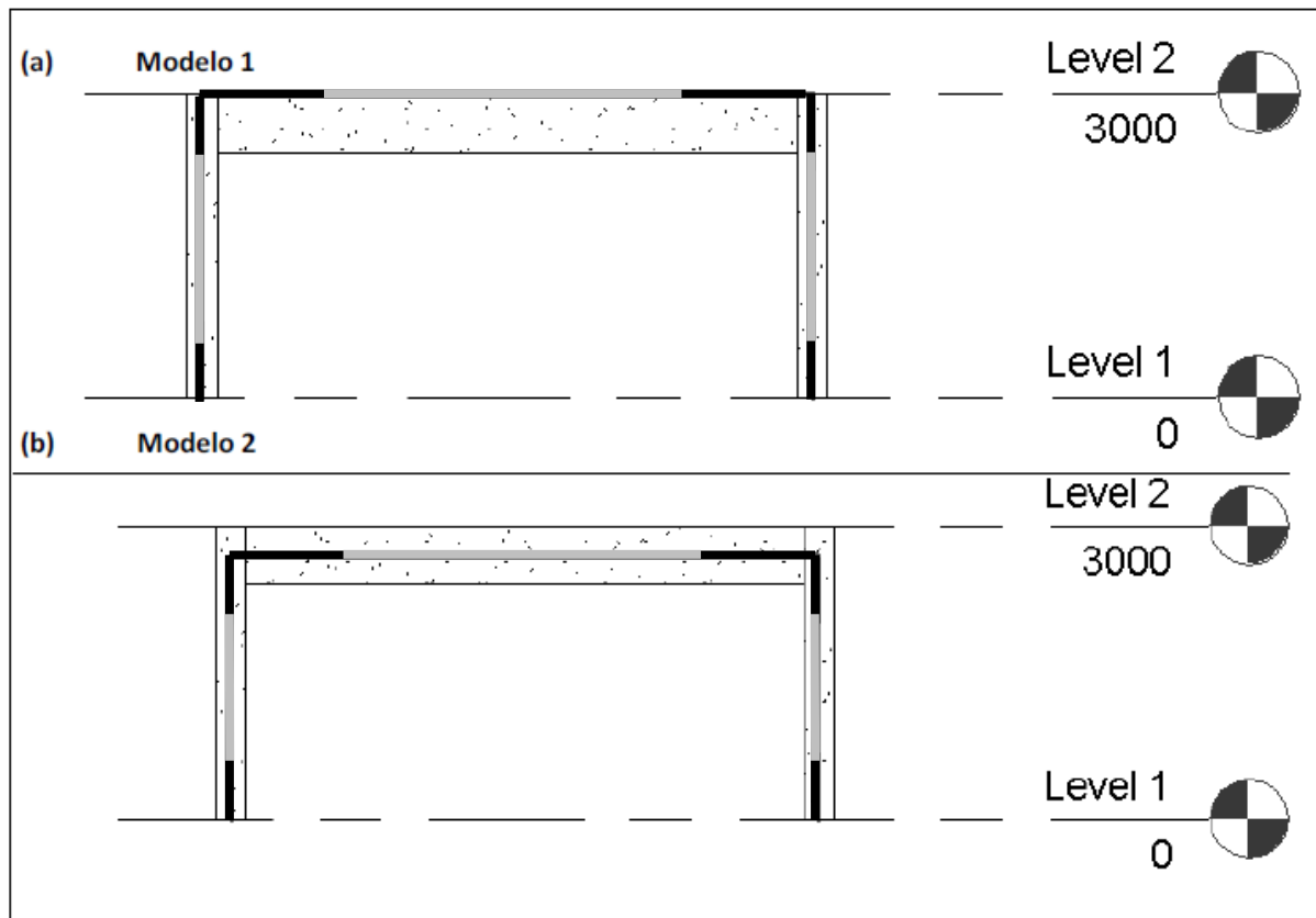
Figura 3: (a) modelo analítico padrão do Revit; (a) Modelo analítico modificado.
