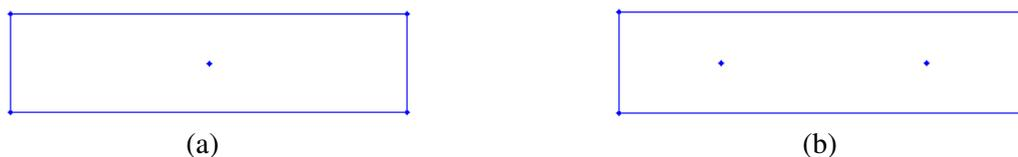
Figura 7. Discretização do modelo em um elemento de contorno por lado
