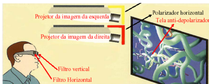
Figura 11.13 – Projeção Polarizada da Luz.
