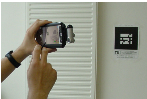
2.2(a): Sistema PDA e marcadores para localização
