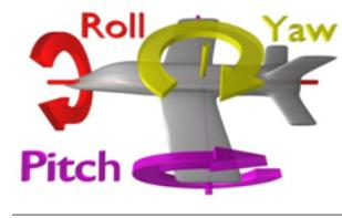
Figura 1. Ângulos de euler calculados pela bússola.
