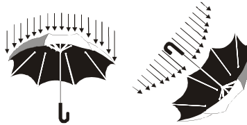
Figura 14. 10 - Membrana Tencionada de um Guarda-Chuva
