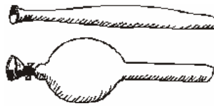
Figura 14. 7 - Deformação em Estrutura Tubular
