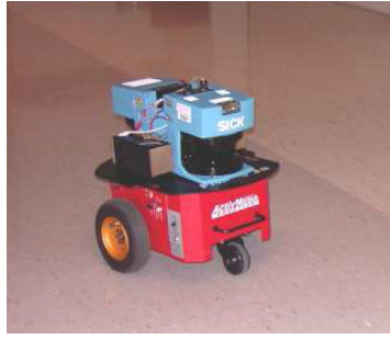
Figura 3.1: Uma montagem clássica de robôs para usar técnicas de SLAM. Fonte: [28]
