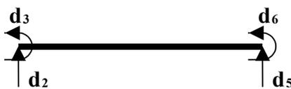
Figura 2.9 – Elemento de viga
