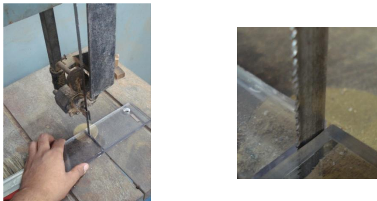
Figura 4.8 - Usinado dos entalhes em corpos de prova tipo ESE(T)
