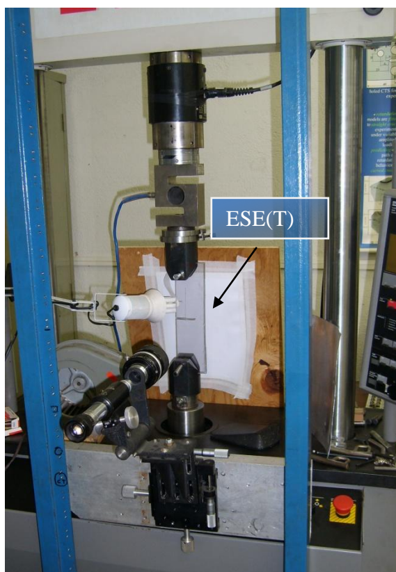
Figura 4.10 – Ensaio de K-Decreasing e K-Increasing para conhecer as propriedades a fadiga do PC, Corpo de prova ESE(T), (Lab. Fadiga PUC-Rio, 2010)
