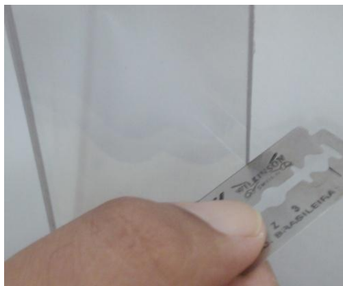
Figura 4.14 – Introdução do defeito de raio muito pequeno no C2D-PC com uso de um Gillette de barbear, (Lab. Fadiga PUC-Rio, 2010)
