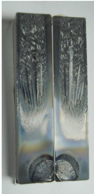
Figura 5.23 – Fratura frágil em trinca bidimensional a/t < 1 , C2D-08,09 com numero de ciclos, a geometria éfeita com dados experimentais da propagação.
