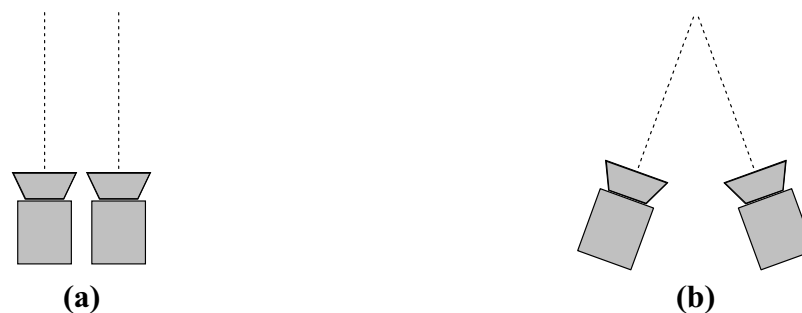
Figura 13.8 – Configuração de Câmeras: a) Câmeras em Eixo Paralelo e b) Câmeras em Eixo Convergente.
