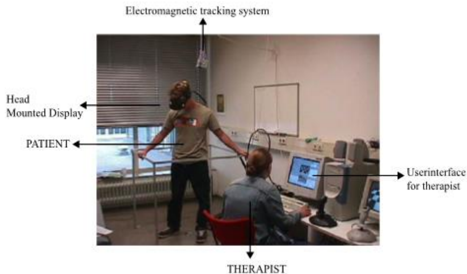
Figura 1 – Head-Mounted Display (HMD) (Krijn, Emmelkamp, Biemond, de Ligny, Schuemie & van der Mast, 2004)
