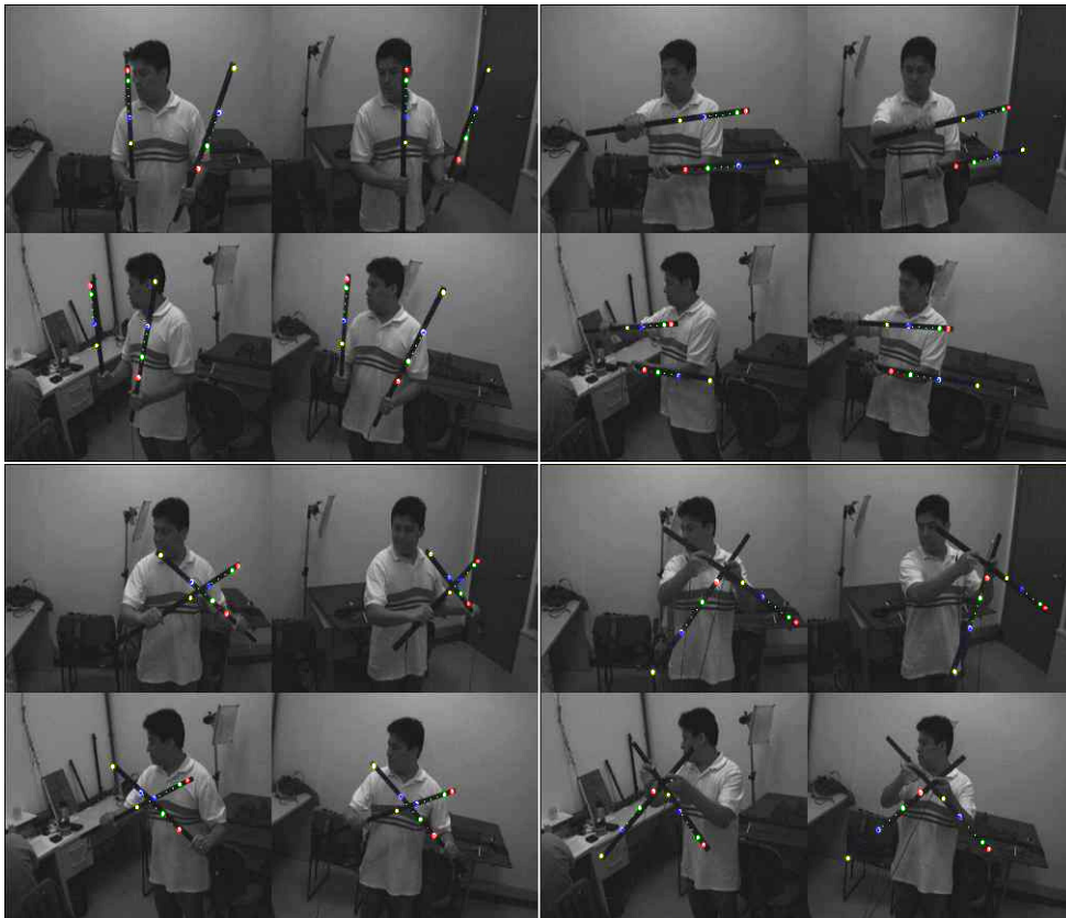
Figura 24: Captura simultânea dois padrões invariantes num sistema de quatro câmeras.
