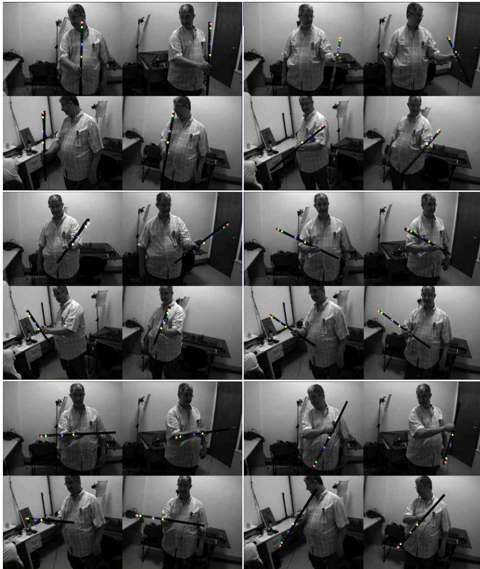
Figura 22: Processo de treinamento feito simultaneamente num sistema de 4 câmeras.
