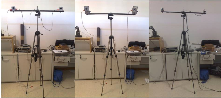
Figura 33: Três sistemas estéreo de câmeras formados pelas seis câmeras usadas para os testes.
