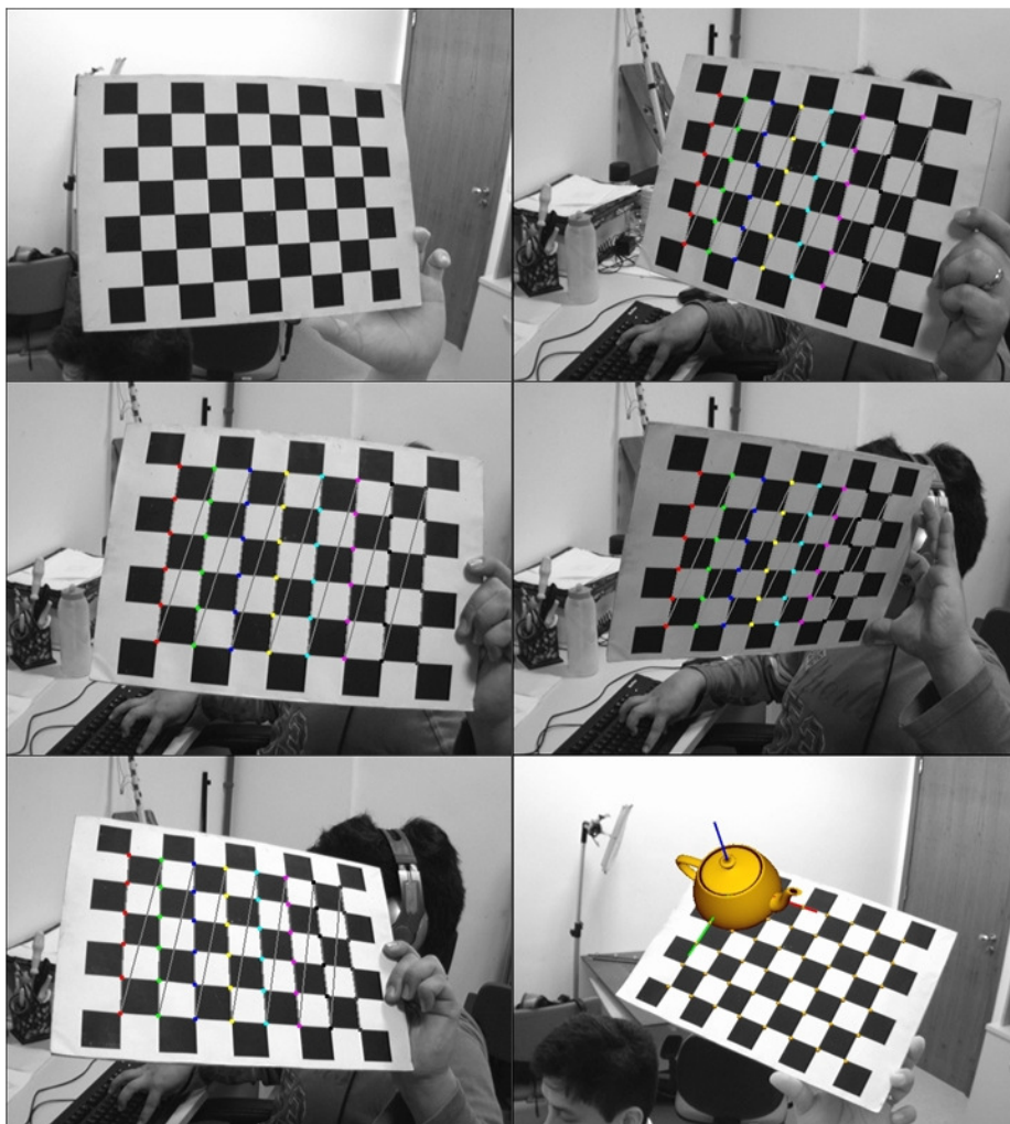
Figura 21: Captura do padrão planar para calibração fotogramétrica.
