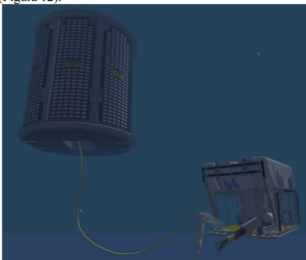
Figura 12 - Visualização de cena com TMS, Tether e ROV.
