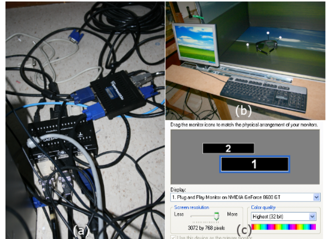
Figura 7. (a) Dois splitters Matrox TripleHead2Go para estender (b) um desktop ao longo das telas da HybridDesk (c) através de uma placa gráfica com duas saídas de vídeo.
