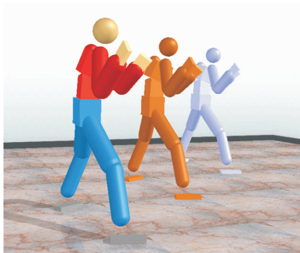
Figura 1. Movimento capturado original (direita); Simulação auxiliar (centro) calcula o termo feedforward usando feedback de altos ganhos; Simulação principal (esquerda) combina feedforward com feedback de baixos ganhos.
