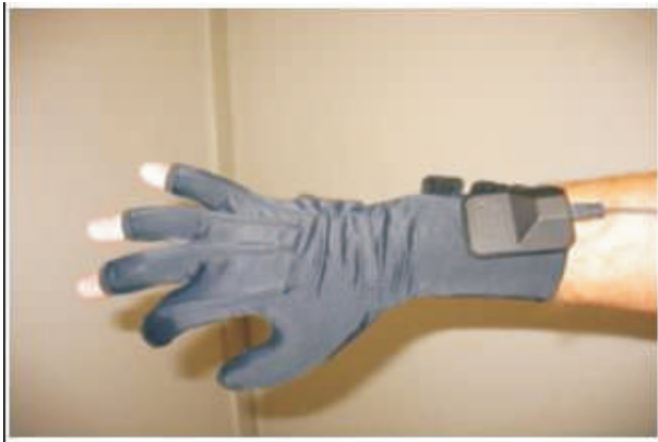
Figura 1. Flexão dos dedos proporcionada pelo equipamento DataGlove 5 Ultra [6].
