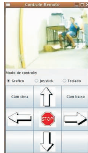
Figura 9. Protótipo do controle da plataforma robótica.
