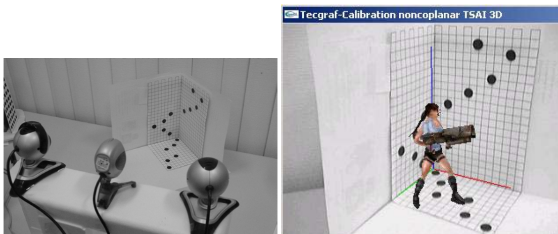
Figura 7.49 –Aplicação de RA: à esquerda estão as câmeras filmando o marcador real, à direita é a imagem final, com a personagem virtual sobreposta à imagem filmada.
