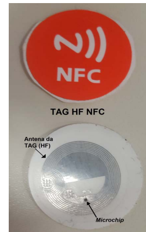
Figura 6. Etiquetas HF NFC (Near Field Communication) usadas na demonstração.
