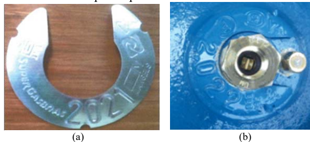
Figura 1. (a) plaqueta de identificação da requalificação - "ferradura", (b) acabamento final, após pintura.
