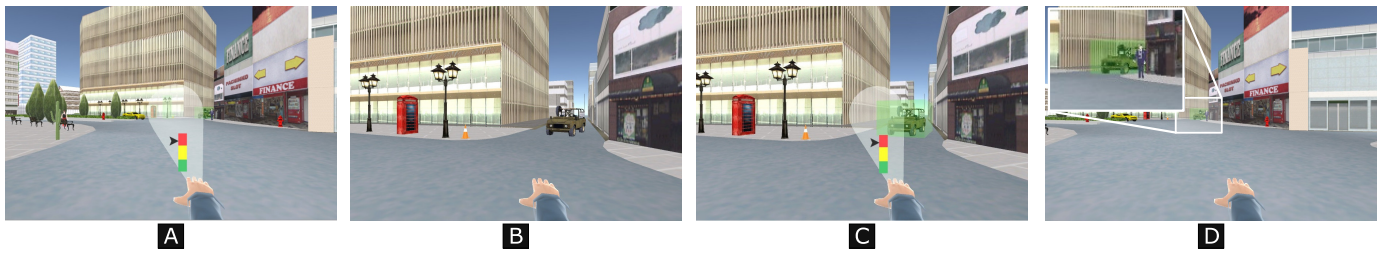
Fig. 5: Técnica de seleção para objetos fora do alcance. A) Cone a intersectar vários objetos. B) Refinamento. C) Seleção de um único objeto. D) Fase final com objeto selecionado.
